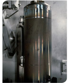
Eine HAW-Kokille wird automatisch verschweißt
