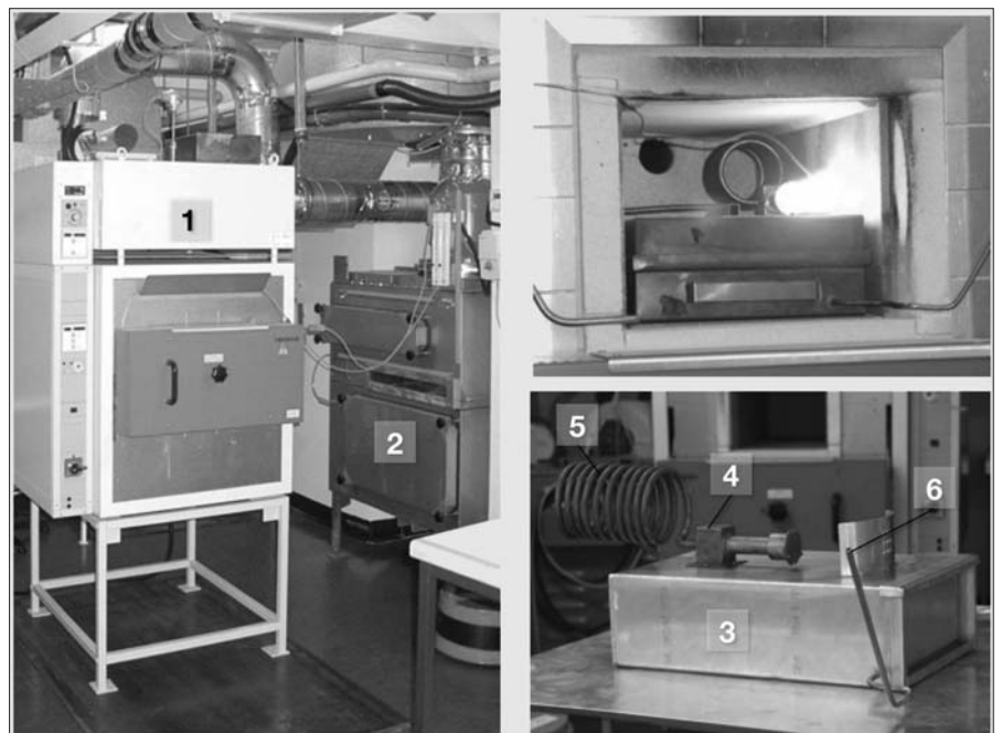
Bild 3: Bild links: Thermische Behandlungsanlage (TBA), bestehend aus Laborofen mit katalytischer Nachverbrennung (1) und nachgeschalteter Filtereinheit (2). Bild rechts oben: Versuchsanordnung III, erste Probeläufe: Venturibrenner auf Pyrolysekammer (Simulationslauf bei 650 °C). Bild rechts unten: Endgültige Versuchsanordnung III, zur Konditionierung der SUR-Brennstoffplatten; Inconel-Pyrolysekammer (3) mit Venturibrenner (4), Druckluftvorheizung (5) und Inertgaszuleitung (6).
